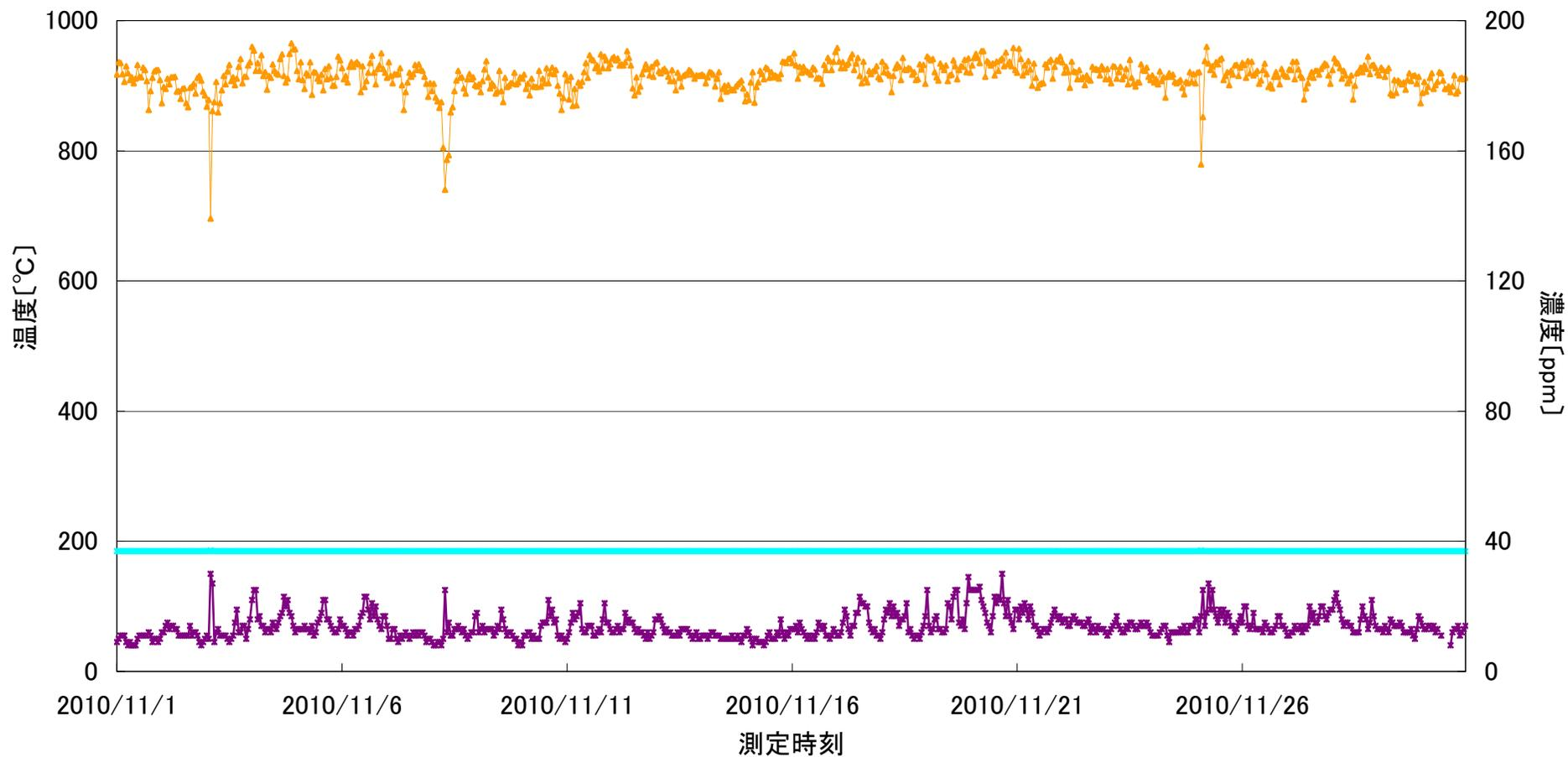
—●— 燃焼室ガス温度 [°C]    —★— バグ入口温度 [°C]    —■— 一酸化炭素濃度 [ppm]
