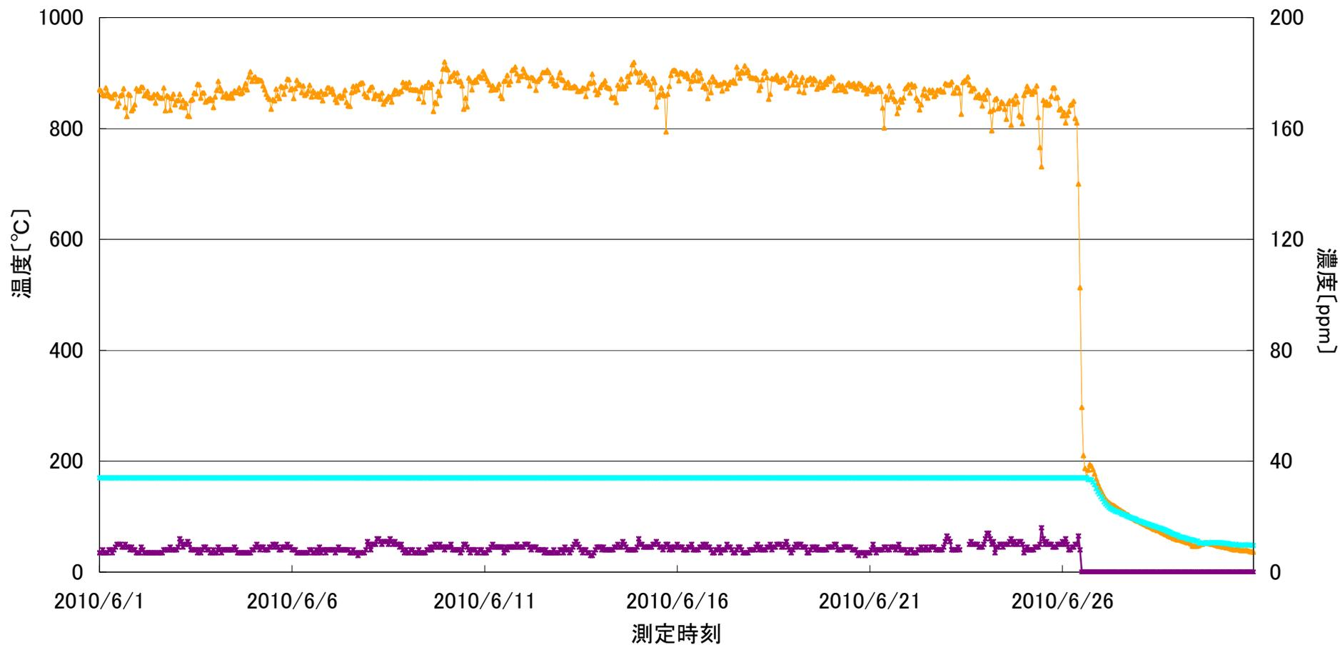
—●— 燃烧室ガス温度[°C] —★— バグ入口温度[°C] —■— 一酸化炭素濃度[ppm]
