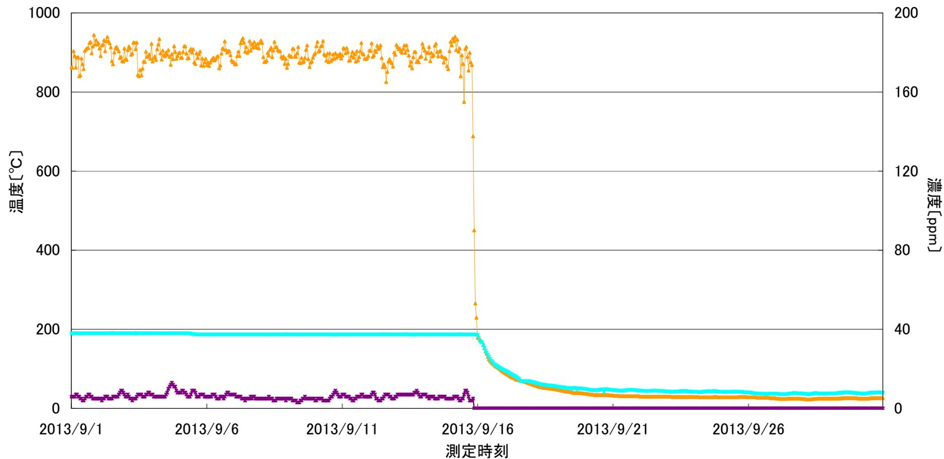
—●— 燃焼室ガス温度[°C] —★— バグ入口温度[°C] —■— 一酸化炭素濃度[ppm]
