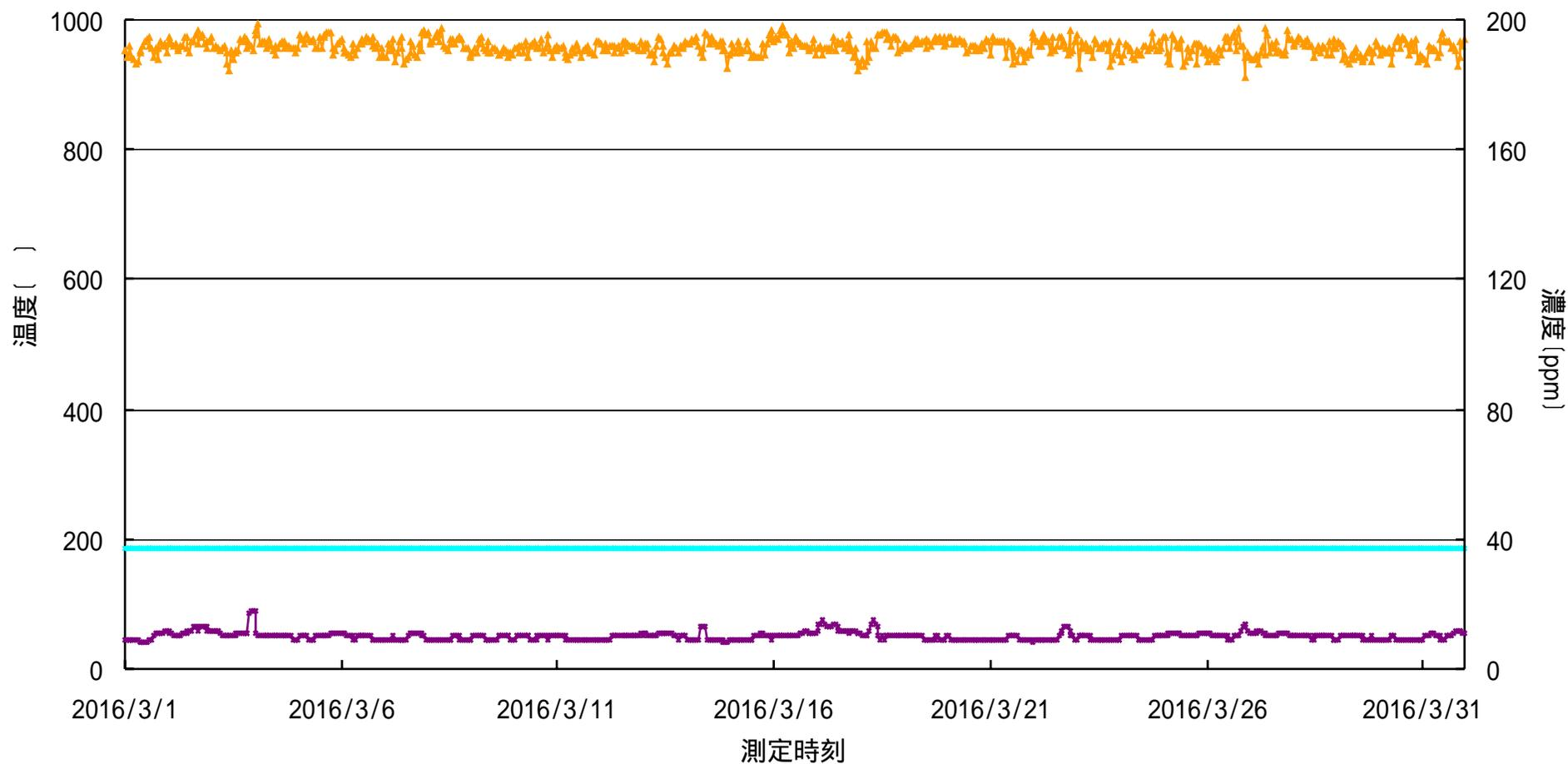
—●— 燃烧室ガス温度 (°C)    —●— バグ入口温度 (°C)    —●— 一酸化炭素濃度 (ppm)
