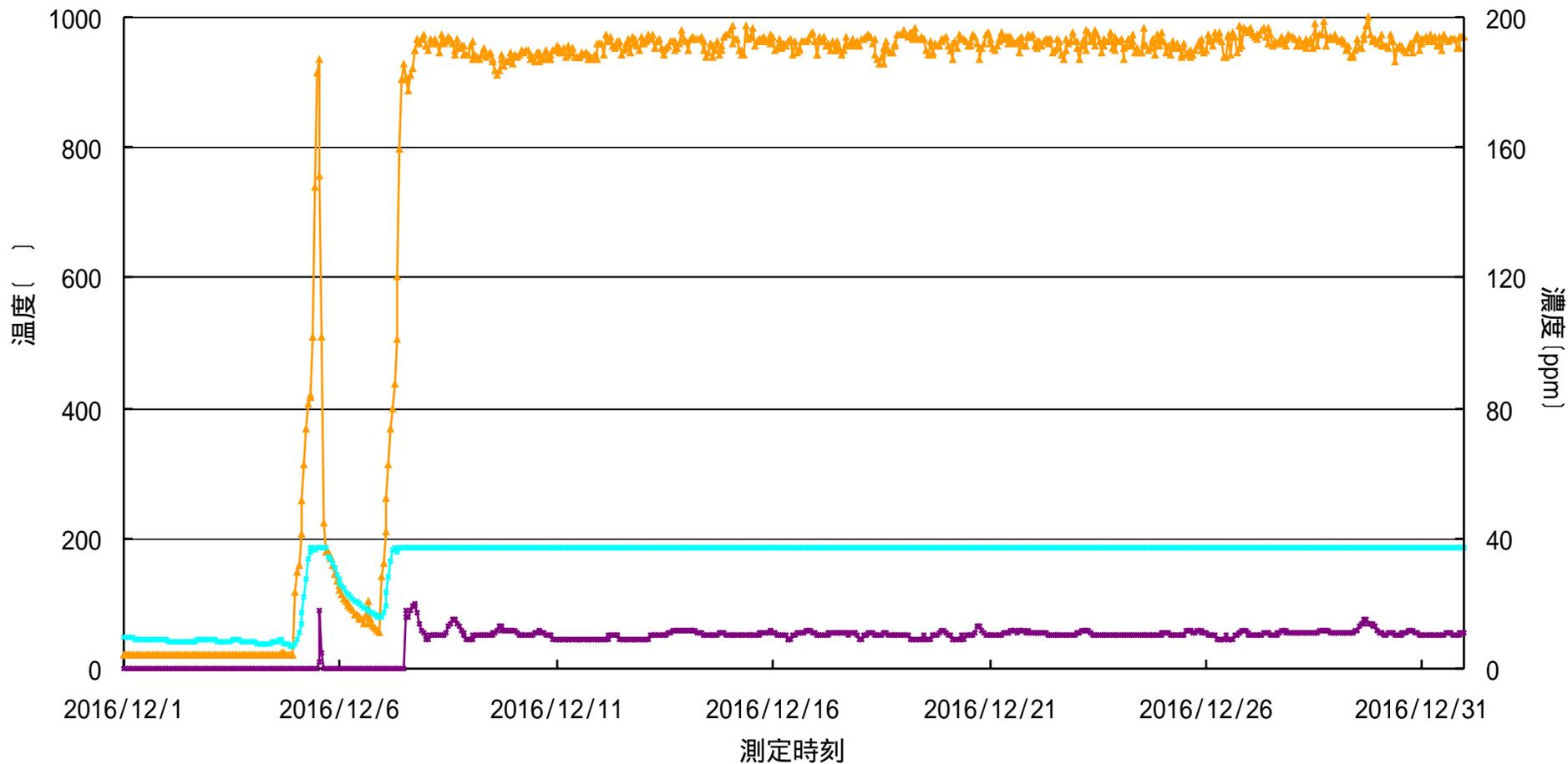
—●— 燃烧室ガス温度( ) —●— バグ入口温度( ) —●— 一酸化炭素濃度 (ppm)
