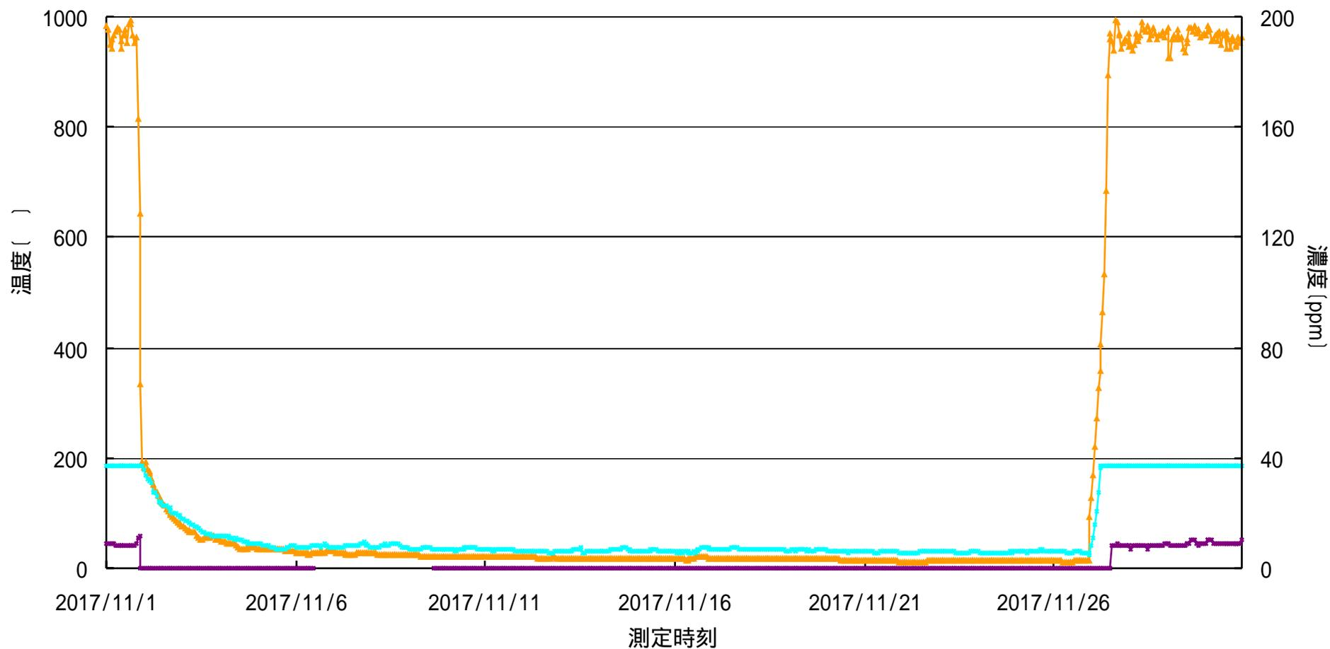
—●— 燃焼室ガス温度 [°C] —■— バグ入口ガス温度 [°C] —●— 一酸化炭素濃度 [ppm]
